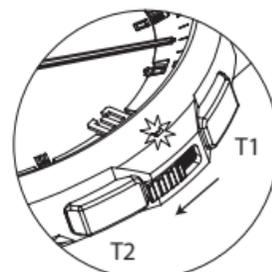
Tastensperre durch Sicherheitsschieber:
