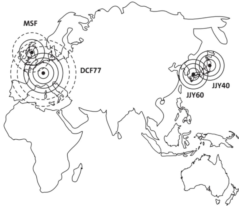
Junghans MEGA配备一个多频无线电波控制机芯。腕表能够从以下时间信号发射塔自动接收信号：
